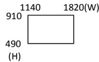
●W・Hは、窓外枠(ユニット)寸法を示します。
